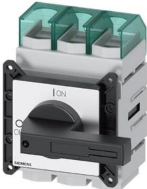
SENTRON, sezionatore sottocarico 3LD5 UL, interruttore principale, a 3 poli, approvato secondo UL489, UL60947-4-1 e IEC60947-3, UL: 100 A, SCCR 65 kA con AC 480 V, potenza di impiego con AC 480 V trifase: 60 hp, IEC: 100 A, potenza di impiego con AC-23A con 400 V: 45 kW, fissato frontalmente: comando rotativo, nero, fissaggio a 4 fori dell'operatore, incl. calotte coprimorsetti per il lato alimentazione
