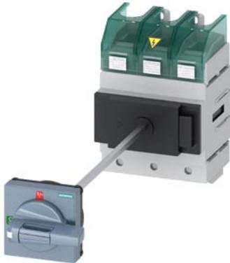
SETRON, sezionatore sottocarico 3LD5 UL, interruttore principale, a 3 poli, approvato secondo UL489, UL60947-4-1 e IEC60947-3, UL: 100 A, SCCR 65 kA con AC 480 V, potenza di impiego con AC 480 V trifase: 60 hp, IEC: 100 A, potenza di impiego con AC-23A con 400 V: 45 kW, fissaggio su base con bloccoporta, aggirabile comando rotativo, standard, 4 fori per fissaggio dell'operatore, senza compensazione della tolleranza, incluse calotte coprimorsetti per il lato alimentazione
