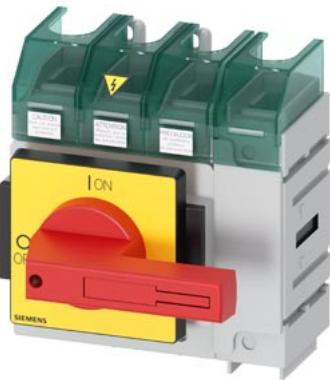
SENTRON, sezionatore sottocarico 3LD5 UL, interruttore di OFF di emergenza, a 4 poli, approvato secondo UL489, UL60947-4-1 e IEC60947-3, UL: 100 A, SCCR 65 kA con AC 480 V, potenza di impiego con AC 480 V trifase: 60 hp, IEC: 100 A, potenza di impiego con AC-23A con 400 V: 45 kW, fissaggio su base con comando diretto, rosso/giallo incluse calotte coprimorsetti per il lato alimentazione
