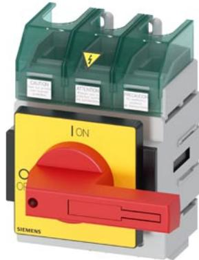
SETRON, sezionatore sottocarico 3LD5 UL, interruttore di OFF di emergenza, a 3 poli, approvato secondo UL489, UL60947-4-1 e IEC60947-3, UL: 100 A, SCCR 65 kA con AC 480 V, potenza di impiego con AC 480 V trifase: 60 hp, IEC: 100 A, potenza di impiego con AC-23A con 400 V: 45 kW, fissaggio su base con comando diretto, rosso/giallo include calotte coprimorsetti per il lato alimentazione
