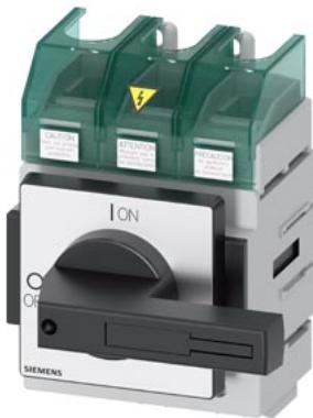
SENTRON, sezionatore sottocarico 3LD5 UL, interruttore principale, a 3 poli, approvato secondo UL489, UL60947-4-1 e IEC60947-3, UL: 100 A, SCCR 65 kA con AC 480 V, potenza di impiego con AC 480 V trifase: 60 hp, IEC: 100 A, potenza di impiego con AC-23A con 400 V: 45 kW, fissaggio su base con comando diretto, nero, incluse calotte coprimorsetti per il lato alimentazione
