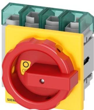
SENTRON, sezionatore sottocarico 3LD5 UL, interruttore di OFF di emergenza, a 4 poli, approvato secondo UL489, UL60947-4-1 e IEC60947-3, UL: 60A, SCCR 50 kA con AC 480 V, potenza di impiego con AC 480 V trifase: 40hp, IEC: 63A, potenza di impiego con AC-23A con 400 V: 30 kW, fissato frontalmente, comando rotativo, rosso/giallo, 4 fori per fissaggio dell'operatore, incluse calotte coprimorsetti per il lato alimentazione
