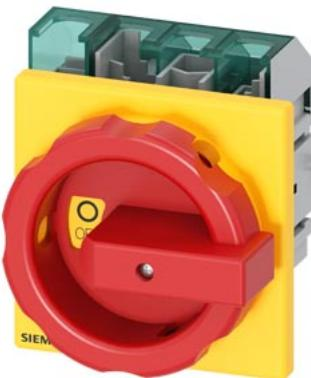
SENTRON, sezionatore sottocarico 3LD5 UL, interruttore di OFF di emergenza, a 4 poli, approvato secondo UL489, UL60947-4-1 e IEC60947-3, UL: 30 A, SCCR 50 kA con AC 480 V, potenza di impiego con AC 480 V trifase: 20 hp, IEC: 32 A, potenza di impiego con AC-23A con 400 V: 15 kW, fissato frontalmente: comando rotativo, rosso/giallo, fissaggio a 4 fori dell'operatore, incl. calotte coprimorsetti per il lato alimentazione
