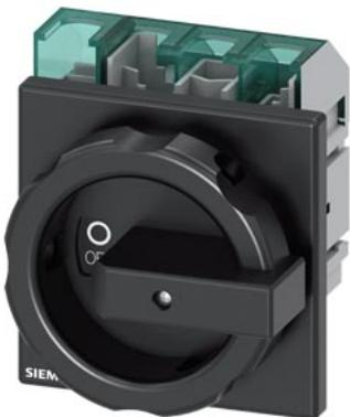
SENTRON, sezionatore sottocarico 3LD5 UL, interruttore principale, a 4 poli, approvato secondo UL489, UL60947-4-1 e IEC60947-3, UL: 30 A, SCCR 50 kA con AC 480 V, potenza di impiego con AC 480 V trifase: 20 hp, IEC: 32 A, potenza di impiego con AC-23A con 400 V: 15 kW, fissato frontalmente: comando rotativo, nero, fissaggio a 4 fori dell'operatore, incl. calotte coprimorsetti per il lato alimentazione
