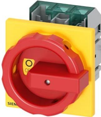
SETRON, sezionatore sottocarico 3LD5 UL, interruttore di OFF di emergenza, a 3 poli, approvato secondo UL489, UL60947-4-1 e IEC60947-3, UL: 30 A, SCCR 50 kA con AC 480 V, potenza di impiego con AC 480 V trifase: 20 hp, IEC: 32 A, potenza di impiego con AC-23A con 400 V: 15 kW, fissaggio frontale: comando rotativo, rosso/giallo, fissaggio a 4 fori dell'operatore, incl. calotte coprimorsetti per il lato alimentazione
