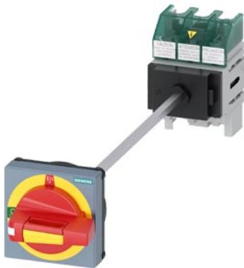
SENTRON, sezionatore sottocarico 3LD5 UL, interruttore di OFF di emergenza, a 3 poli, approvato secondo UL489, UL60947-4-1 e IEC60947-3, UL: 30 A, SCCR 50 kA con AC 480 V, potenza di impiego con AC 480 V trifase: 20 hp, IEC: 32 A, potenza di impiego con AC-23A con 400 V: 15 kW, fissaggio su base con bloccoporta, aggirabile comando rotativo, OFF di emergenza, 4 fori per fissaggio dell'operatore, senza compensazione della tolleranza, incluse calotte coprimorsetti per il lato alimentazione
