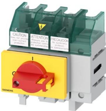
SENTRON, sezionatore sottocarico 3LD5 UL, interruttore di OFF di emergenza, a 4 poli, approvato secondo UL489, UL60947-4-1 e IEC60947-3, UL: 30 A, SCCR 50 kA con AC 480 V, potenza di impiego con AC 480 V trifase: 20 hp, IEC: 32 A, potenza di impiego con AC-23A con 400 V: 15 kW, fissaggio su base con comando diretto, rosso/giallo incluse calotte coprimorsetti per il lato alimentazione
