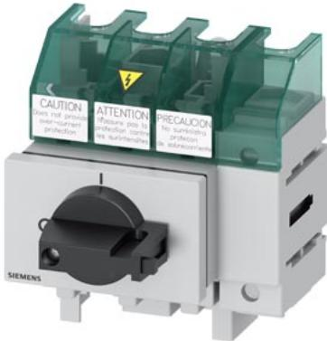
SENTRON, sezionatore sottocarico 3LD5 UL, interruttore principale, a 4 poli, approvato secondo UL489, UL60947-4-1 e IEC60947-3, UL: 30 A, SCCR 50 kA con AC 480 V, potenza di impiego con AC 480 V trifase: 20 hp, IEC: 32 A, potenza di impiego con AC-23A con 400 V: 15 kW, fissaggio su base con comando diretto, nero, incluse calotte coprimorsetti per il lato alimentazione
