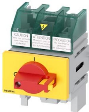
SETRON, sezionatore sottocarico 3LD5 UL, interruttore di OFF di emergenza, a 3 poli, approvato secondo UL489, UL60947-4-1 e IEC60947-3, UL: 30 A, SCCR 50 kA con AC 480 V, potenza di impiego con AC 480 V trifase: 20 hp, IEC: 32 A, potenza di impiego con AC-23A con 400 V: 15 kW, fissaggio su base con comando diretto, rosso/giallo include calotte coprimorsetti per il lato alimentazione
