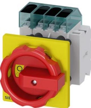
sezionatore sottocarico 3LD3, Iu 63 A interruttore principale a 3 poli + N potenza di impiego nominale per AC-23 A con 400 V 22,0 kW fissaggio frontale interruttore base con fissaggio su foro centrale 22,5 mm comando a leva rosso/giallo 66x66 mm con blocchetto di contatti ausiliari 1NC+1NO
