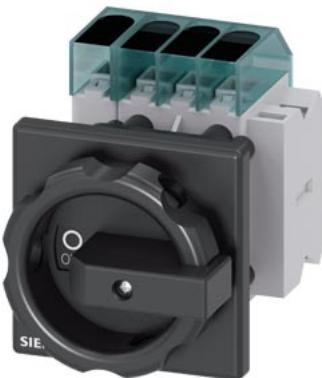
sezionatore sottocarico 3LD3, Iu 63 A interruttore principale a 3 poli + N potenza di impiego nominale per AC-23 A con 400 V 22,0 kW fissaggio frontale interruttore base con fissaggio su foro centrale 22,5 mm comando a leva nero 66x66 mm con blocchetto di contatti ausiliari 1NC+1NO
