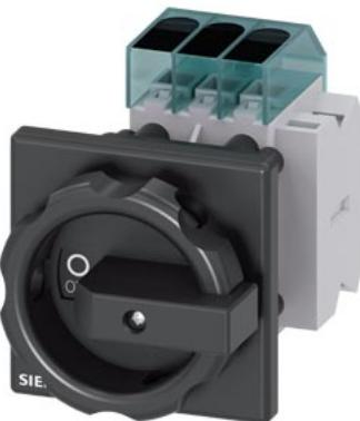
sezionatore sottocarico 3LD3, Iu 63 A interruttore principale a 3 poli potenza di impiego nominale per AC-23 A con 400 V 22,0 kW fissaggio frontale interruttore base con fissaggio su foro centrale 22,5 mm comando a leva nero 66x66 mm con blocchetto di contatti ausiliari 1NC+1NO
