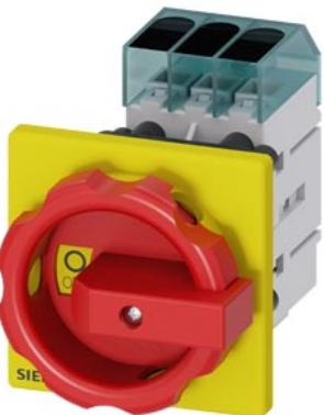
sezionatore sottocarico 3LD3, Iu 63 A interruttore principale a 3 poli potenza di impiego nominale per AC-23 A con 400 V 22,0 kW fissaggio frontale interruttore base con fissaggio su foro centrale 22,5 mm comando a leva rosso/giallo 66x66 mm
