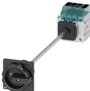
sezionatore sottocarico 3LD3, Iu 63 A interruttore principale a 3 poli + N potenza di impiego nominale per AC-23 A con 400 V 22,0 kW fissaggio sulla base di fondo interruttore base con bloccoporta fissaggio su foro centrale 22,5 mm comando rotativo nero 66 x 66 mm con blocchetto di contatti ausiliari 1NC+1NO
