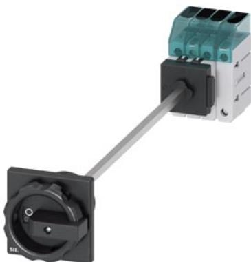
sezionatore sottocarico 3LD3, Iu 63 A interruttore principale a 3 poli + N potenza di impiego nominale per AC-23 A con 400 V 22,0 kW fissaggio sulla base di fondo interruttore base con bloccoporta fissaggio su foro centrale 22,5 mm comando rotativo nero 66 x 66 mm
