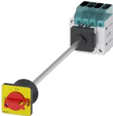
sezionatore sottocarico 3LD3, Iu 63 A interruttore principale a 3 poli + N potenza di impiego nominale per AC-23 A con 400 V 22,0 kW fissaggio sulla base di fondo interruttore base con bloccoporta fissaggio su foro centrale 22,5 mm comando a leva rosso/giallo 48x48 mm con blocchetto di contatti ausiliari 1NC+1NO
