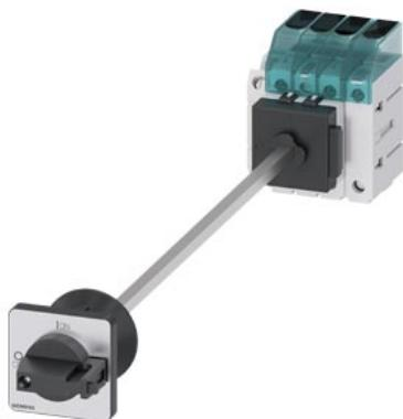
sezionatore sottocarico 3LD3, Iu 63 A interruttore principale a 3 poli + N potenza di impiego nominale per AC-23 A con 400 V 22,0 kW fissaggio sulla base di fondo interruttore base con bloccoporta fissaggio su foro centrale 22,5 mm comando a leva nero 48x48 mm con blocchetto di contatti ausiliari 1NC+1NO
