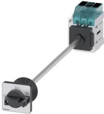
sezionatore sottocarico 3LD3, lu 63 A interruttore principale a 3 poli potenza di impiego nominale per AC-23 A con 400 V 22,0 kW fissaggio sulla base di fondo interruttore base con bloccoporta fissaggio su foro centrale 22,5 mm comando a leva nero 48x48 mm con blocchetto di contatti ausiliari 1NC+1NO
