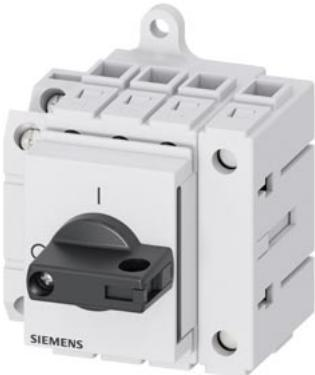
sezionatore sottocarico 3LD3, Iu 63 A interruttore principale a 3 poli + N potenza di impiego nominale per AC-23 A con 400 V 22,0 kW montaggio nel quadro di distribuzione interruttore base con comando a leva nero con blocchetto di contatti ausiliari 1NC+1NO
