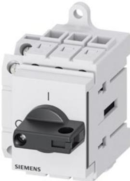
sezionatore sottocarico 3LD3, Iu 63 A interruttore principale a 3 poli potenza di impiego nominale per AC-23 A con 400 V 22,0 kW montaggio nel quadro di distribuzione interruttore base con comando a leva nero con blocchetto di contatti ausiliari 1NC+1NO
