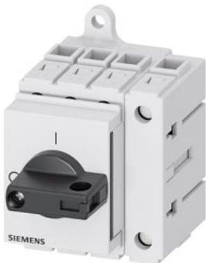
sezionatore sottocarico 3LD3, Iu 63 A interruttore principale a 3 poli + N potenza di impiego nominale per AC-23 A con 400 V 22,0 kW montaggio nel quadro di distribuzione interruttore base con comando a leva nero
