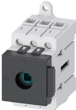
sezionatore sottocarico 3LD3, Iu 63 A interruttore principale a 3 poli potenza di impiego nominale per AC-23A con 400V 22,0kW interruttore base senza comando a leva
