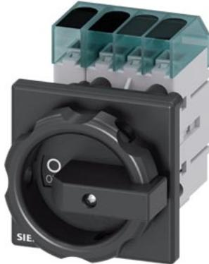
sezionatore sottocarico 3LD3, Iu 40 A interruttore principale a 3 poli + N potenza di impiego nominale per AC-23 A con 400 V 18,5 kW fissaggio frontale interruttore base con fissaggio su foro centrale 22,5 mm comando a leva nero 66x66 mm
