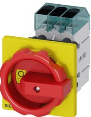
sezionatore sottocarico 3LD3, Iu 40 A interruttore principale a 3 poli potenza di impiego nominale per AC-23 A con 400 V 18,5 kW fissaggio frontale interruttore base con fissaggio su foro centrale 22,5 mm comando a leva rosso/giallo 66x66 mm
