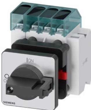
sezionatore sottocarico 3LD3, Iu 40 A interruttore principale a 3 poli + N potenza di impiego nominale per AC-23 A con 400 V 18,5 kW fissaggio frontale interruttore base con fissaggio su foro centrale 22,5 mm comando a leva nero 48x48 mm con blocchetto di contatti ausiliari 1NC+1NO
