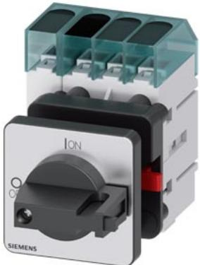
sezionatore sottocarico 3LD3, Iu 40 A interruttore principale a 3 poli + N potenza di impiego nominale per AC-23 A con 400 V 18,5 kW fissaggio frontale interruttore base con fissaggio su foro centrale 22,5 mm comando a leva nero 48x48 mm
