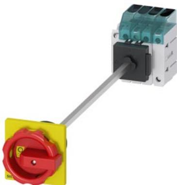
sezionatore sottocarico 3LD3, Iu 40 A interruttore principale a 3 poli + N potenza di impiego nominale per AC-23 A con 400 V 18,5 kW fissaggio sulla base di fondo interruttore base con bloccoporta fissaggio su foro centrale 22,5 mm comando rotativo rosso/giallo 66 x 66 mm con blocchetto di contatti ausiliari 1NC+1NO
