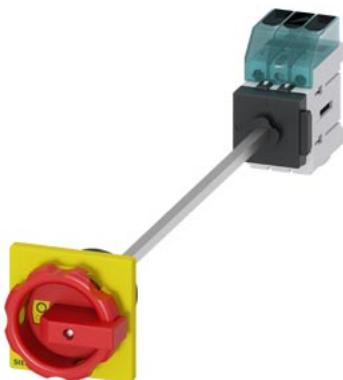
sezionatore sottocarico 3LD3, Iu 40 A interruttore principale a 3 poli potenza di impiego nominale per AC-23 A con 400 V 18,5 kW fissaggio sulla base di fondo interruttore base con bloccoporta fissaggio su foro centrale 22,5 mm comando rotativo rosso/giallo 66 x 66 mm
