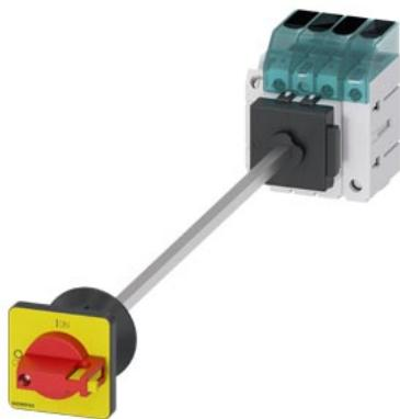
sezionatore sottocarico 3LD3, Iu 40 A interruttore principale a 3 poli + N potenza di impiego nominale per AC-23 A con 400 V 18,5 kW fissaggio sulla base di fondo interruttore base con bloccoporta fissaggio su foro centrale 22,5 mm comando a leva rosso/giallo 48x48 mm con blocchetto di contatti ausiliari 1NC+1NO
