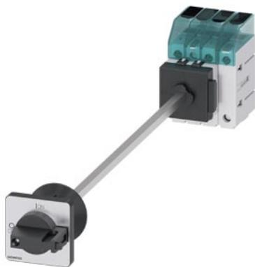
sezionatore sottocarico 3LD3, Iu 40 A interruttore principale a 3 poli + N potenza di impiego nominale per AC-23 A con 400 V 18,5 kW fissaggio sulla base di fondo interruttore base con bloccoporta fissaggio su foro centrale 22,5 mm comando a leva nero 48x48 mm
