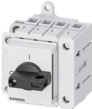
sezionatore sottocarico 3LD3, Iu 40 A interruttore principale a 3 poli + N potenza di impiego nominale per AC-23 A con 400 V 18,5 kW montaggio nel quadro di distribuzione interruttore base con comando a leva nero con blocchetto di contatti ausiliari 1NC+1NO
