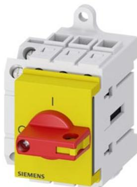
sezionatore sottocarico 3LD3, Iu 40 A interruttore principale a 3 poli potenza di impiego nominale per AC-23 A con 400 V 18,5 kW montaggio nel quadro di distribuzione interruttore base con comando a leva rosso/giallo con blocchetto di contatti ausiliari 1NC+1NO
