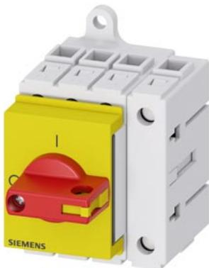
sezionatore sottocarico 3LD3, Iu 40 A interruttore principale a 3 poli + N potenza di impiego nominale per AC-23 A con 400 V 18,5 kW montaggio nel quadro di distribuzione interruttore base con comando a leva rosso/giallo
