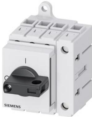
sezionatore sottocarico 3LD3, Iu 40 A interruttore principale a 3 poli + N potenza di impiego nominale per AC-23 A con 400 V 18,5 kW montaggio nel quadro di distribuzione interruttore base con comando a leva nero
