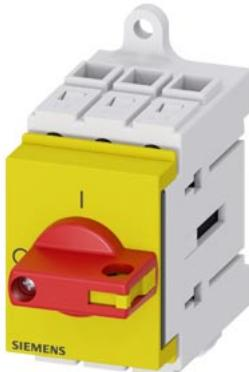
sezionatore sottocarico 3LD3, Iu 40 A interruttore principale a 3 poli potenza di impiego nominale per AC-23 A con 400 V 18,5 kW montaggio nel quadro di distribuzione interruttore base con comando a leva rosso/giallo
