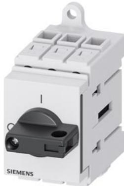
sezionatore sottocarico 3LD3, Iu 40 A interruttore principale a 3 poli potenza di impiego nominale per AC-23 A con 400 V 18,5 kW montaggio nel quadro di distribuzione interruttore base con comando a leva nero
