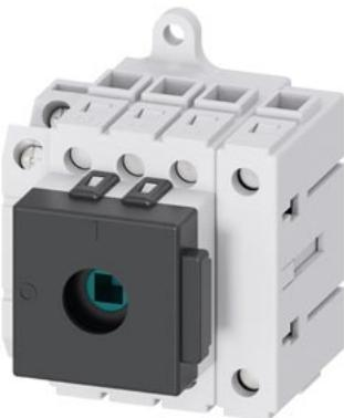
sezionatore sottocarico 3LD3, Iu 40 A interruttore principale a 3 poli + N potenza di impiego nominale per AC-23A con 400V 18,5kW interruttore base senza comando a leva con blocchetto di contatti ausiliari 1NC+1NO
