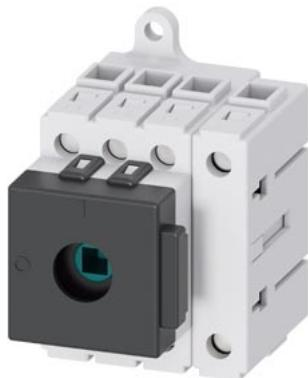
sezionatore sottocarico 3LD3, Iu 40 A interruttore principale a 3 poli + N potenza di impiego nominale per AC-23A con 400V 18,5kW interruttore base senza comando a leva
