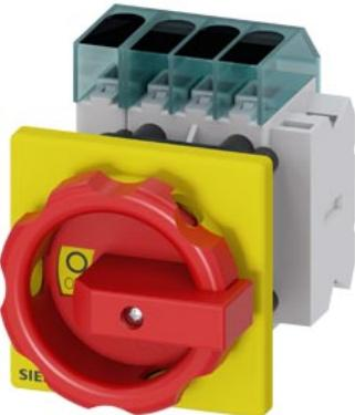
sezionatore sottocarico 3LD3, Iu 32 A interruttore principale a 3 poli + N potenza di impiego nominale per AC-23 A con 400 V 11,5 kW fissaggio frontale interruttore base con fissaggio su foro centrale 22,5 mm comando rotativo rosso/giallo 66 x 66 mm con blocchetto di contatti ausiliari 1NC+1NO
