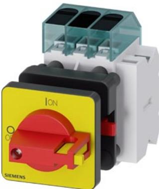
sezionatore sottocarico 3LD3, Iu 32 A interruttore principale a 3 poli potenza di impiego nominale per AC-23 A con 400 V 11,5 kW fissaggio frontale interruttore base con fissaggio su foro centrale 22,5 mm comando a leva rosso/giallo 48x48 mm con blocchetto di contatti ausiliari 1NC+1NO
