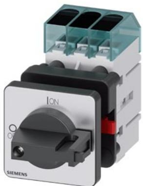
sezionatore sottocarico 3LD3, Iu 32 A interruttore principale a 3 poli potenza di impiego nominale per AC-23 A con 400 V 11,5 kW fissaggio frontale interruttore base con fissaggio su foro centrale 22,5 mm comando a leva nero 48x48 mm
