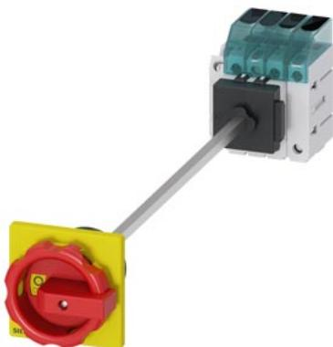
sezionatore sottocarico 3LD3, Iu 32 A interruttore principale a 3 poli + N potenza di impiego nominale per AC-23 A con 400 V 11,5 kW fissaggio sulla base di fondo interruttore base con bloccoporta fissaggio su foro centrale 22,5 mm comando rotativo rosso/giallo 66 x 66 mm con blocchetto di contatti ausiliari 1NC+1NO
