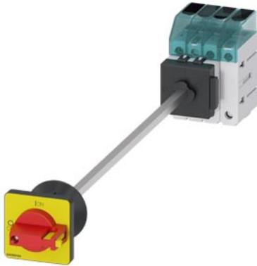
sezionatore sottocarico 3LD3, Iu 32 A interruttore principale a 3 poli + N potenza di impiego nominale per AC-23 A con 400 V 11,5 kW fissaggio sulla base di fondo interruttore base con bloccoporta fissaggio su foro centrale 22,5 mm comando a leva rosso/giallo 48x48 mm
