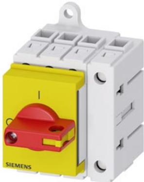
sezionatore sottocarico 3LD3, Iu 32 A interruttore principale a 3 poli + N potenza di impiego nominale per AC-23 A con 400 V 11,5 kW montaggio nel quadro di distribuzione interruttore base con Comando a leva rosso/giallo
