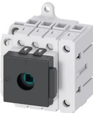
sezionatore sottocarico 3LD3, Iu 32 A interruttore principale a 3 poli + N potenza di impiego nominale per AC-23A con 400V 11,5kW interruttore base senza comando a leva con blocchetto di contatti ausiliari 1NC+1NO
