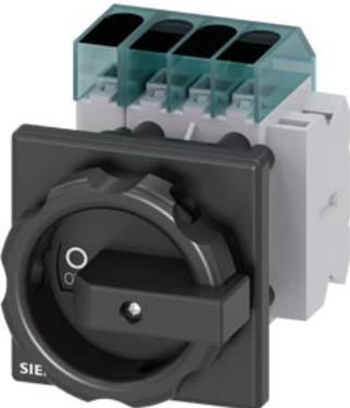
sezionatore sottocarico 3LD3, Iu 25 A interruttore principale a 3 poli + N potenza di impiego nominale per AC-23 A con 400 V 9,0 kW fissaggio frontale interruttore base con fissaggio su foro centrale 22,5 mm comando a leva nero 66x66 mm con blocchetto di contatti ausiliari 1NC+1NO
